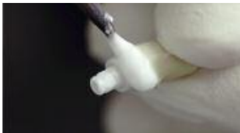
Fig. 19 Eccesso di materiale per brasatura sulla parte di giunzione.
