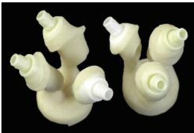
Fig. 5 Caratterizzazioni ottenute mediante sovrappressatura su abutment in ceramica al biossido di zirconio allo stato grezzo dopo la pressatura.
