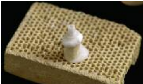
Fig. 21 Il supporto di cottura viene preparato con Hotbond fix, un'ovatta refrattaria pastosa.
